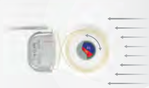
Otočná konstrukce magnetu kochleárního implantátu SYNCHRONY.
